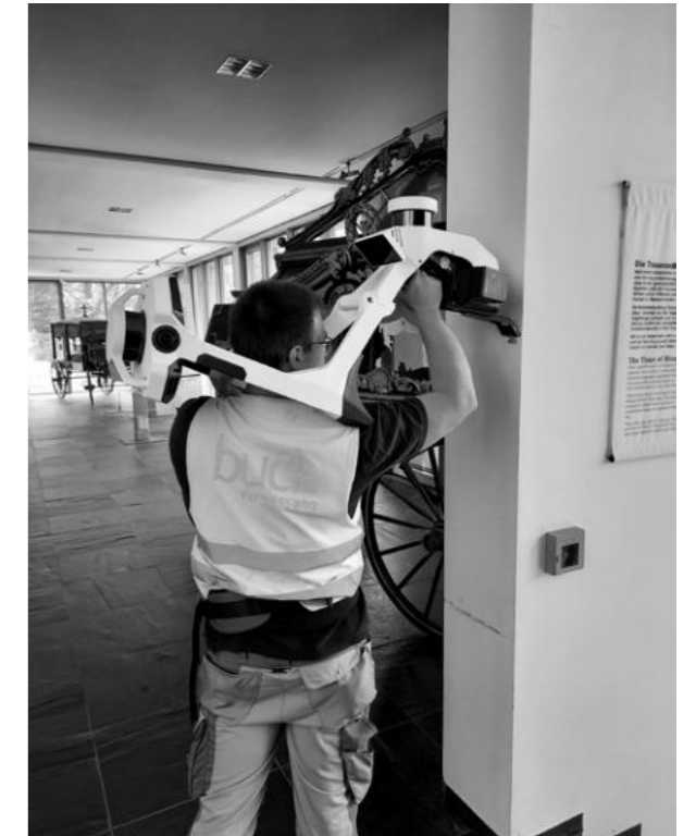
Vermessung: Um im nächsten Schritt eine 3D-Version des bestehenden Museumsgebäudes anzufertigen, waren Mitarbeiter zur Vermessung im Haus unterwegs.
